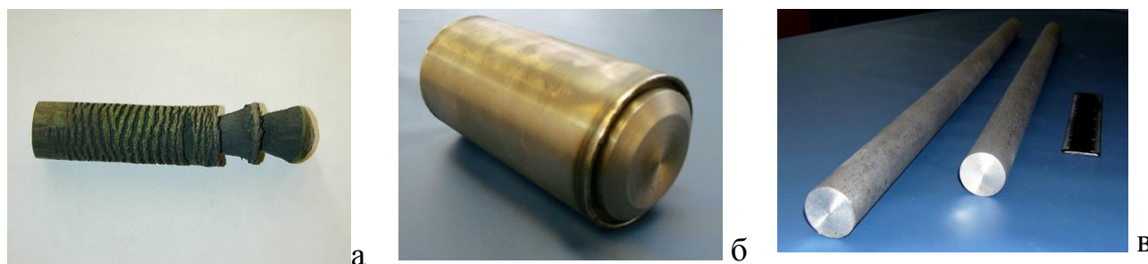
Рисунок 5 - внешний вид выходного конца прутка при прямом прессовании (а), капсулы (б) и прутка, изготовленного прессованием в капсуле (в).
